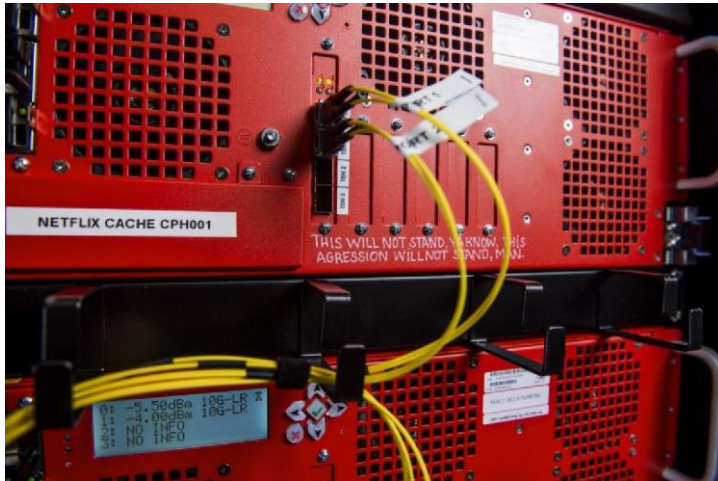
Ilustración 9 Equipamiento Físico de un Servidor CDN Fuente: Netflix.com
