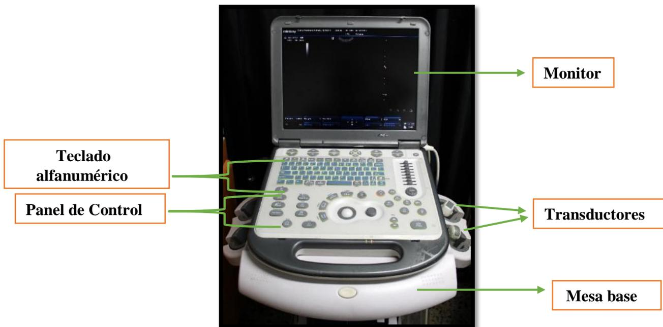
*Ilustración 8: Partes del ecógrafo.*
