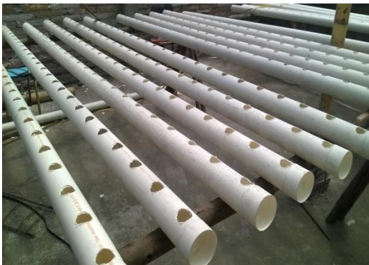
Figura 4. Tubos de PVC sistema NFT.
