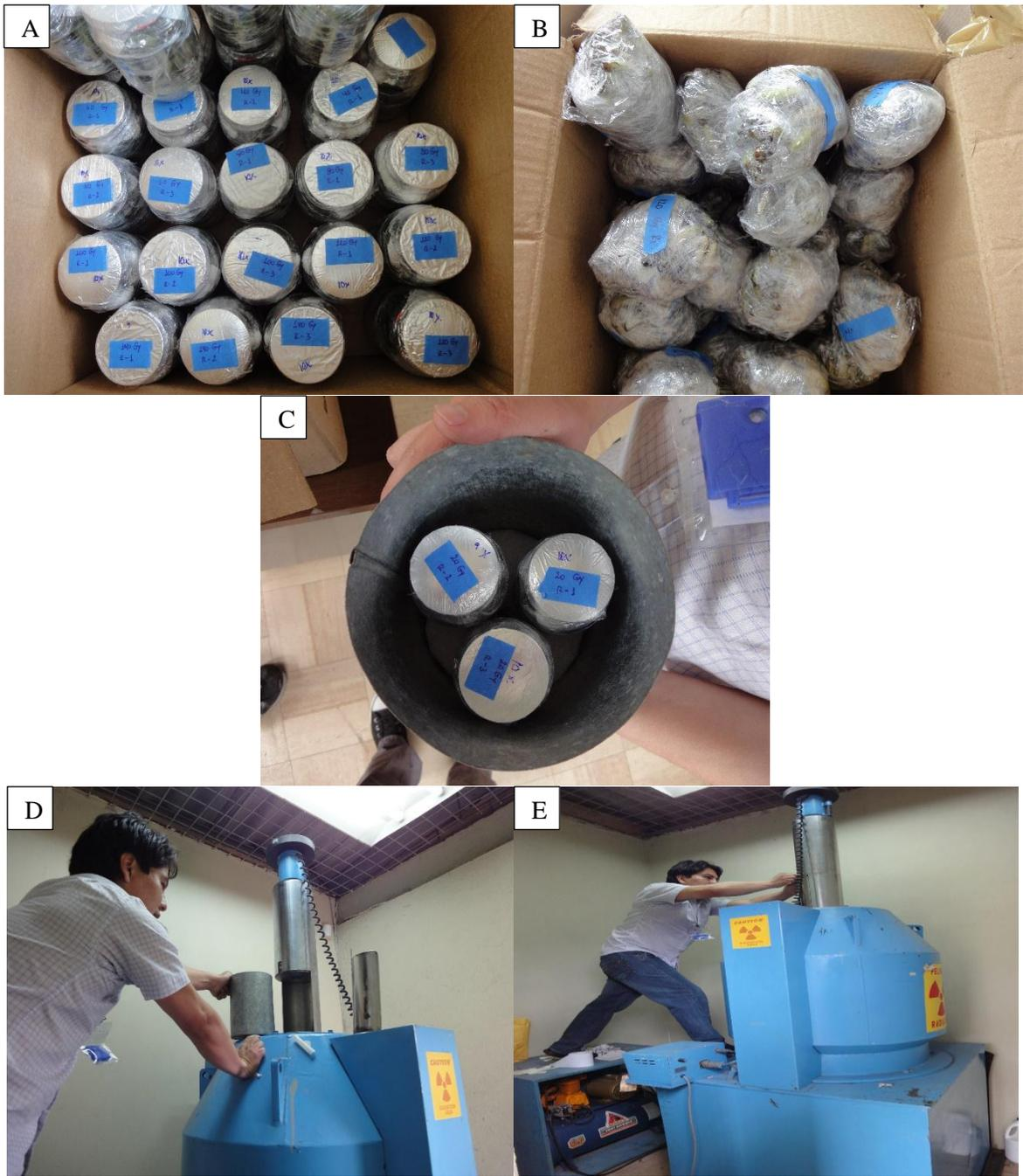
**Figura 2.** Unidad de Irradiación, Dirección Nacional de Investigación y Aplicaciones Nucleares del Ministerio de Electricidad y Energía Renovable: E1 y E2 para ser irradiados (A y B), E1 ubicado en el tambor de irradiación (C), Ubicación del tambor con el E1 dentro del irradiador (D), Sellado del irradiador para el inicio de la irradiación (E).
