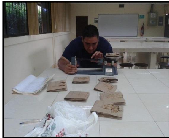
Fig. 30. Resultado de las muestras de la estufa después de 24 horas
