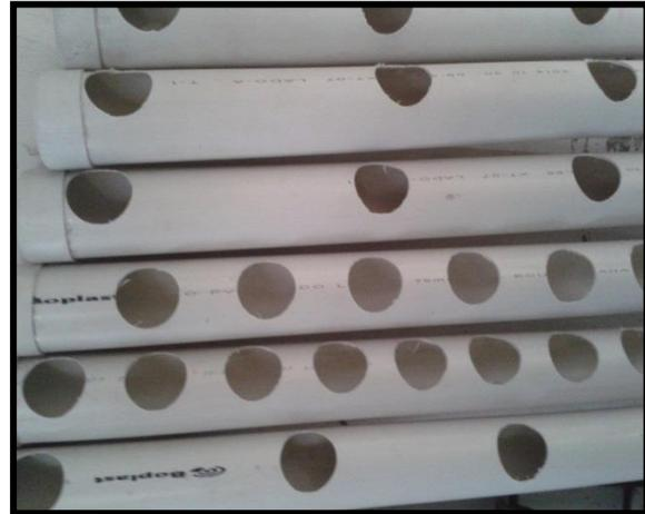
Fig. 7. Perforación de tubos PVC en diferentes medidas
