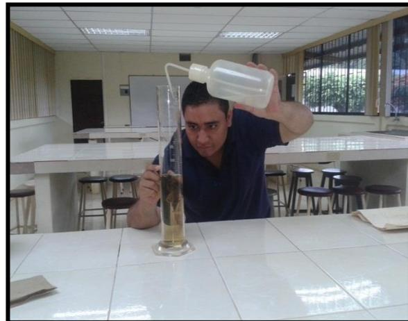
Fig. 32. Probeta aforada a 1000 cc para determinación de la humedad
