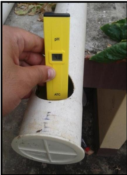
Fig. 31. Medición con el pHmetro en contenedores o bloques
