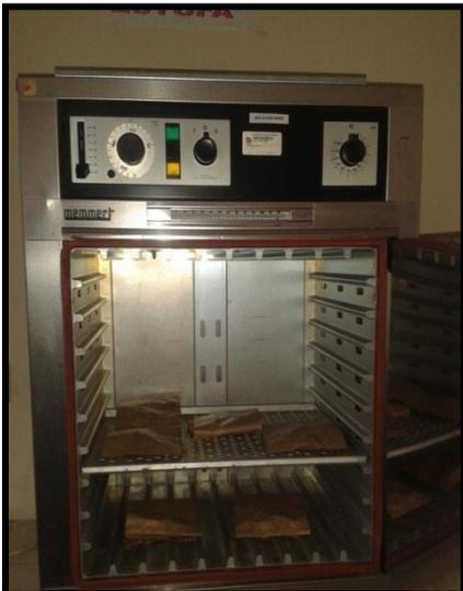
Fig. 29. Colocación de la muestra en la estufa por 24 horas
