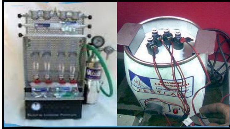
Imagen 2 limpieza de inyectores por diálisis
