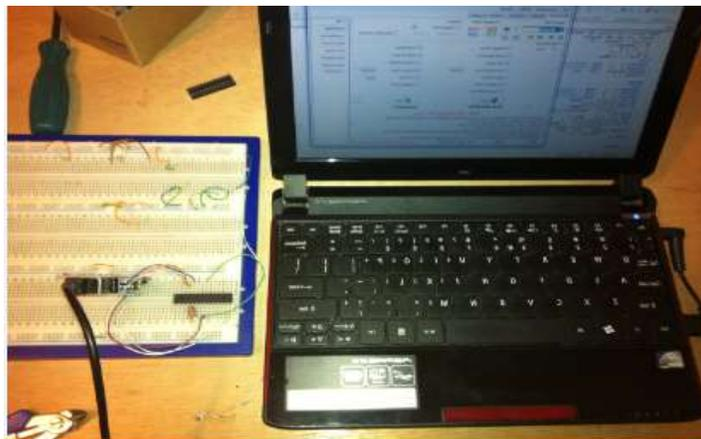
**Figura 4.4** Programación AVR con el atmega 8.
