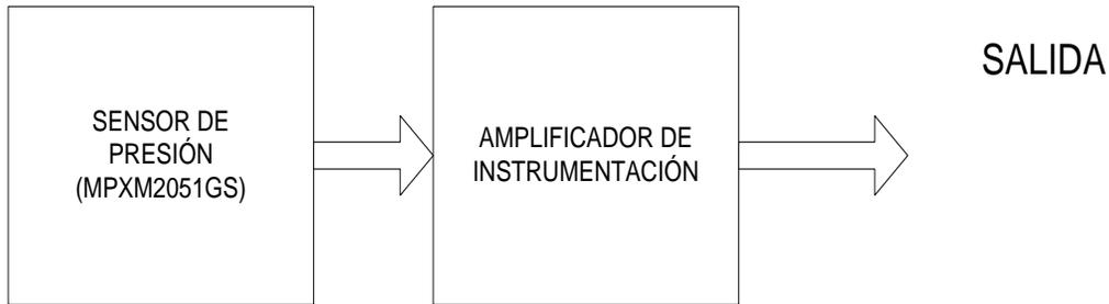
**Figura 2.5** Diagrama de bloques del circuito acondicionador de presión.
