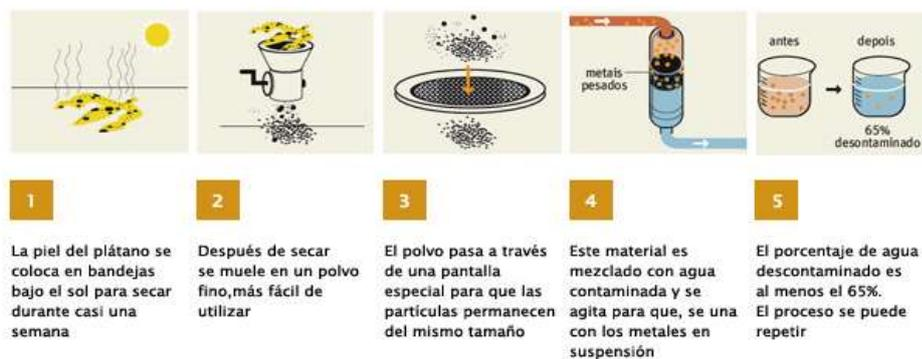
Gráfico 19 Desinfección solar del agua mediante las cascara del banano.
