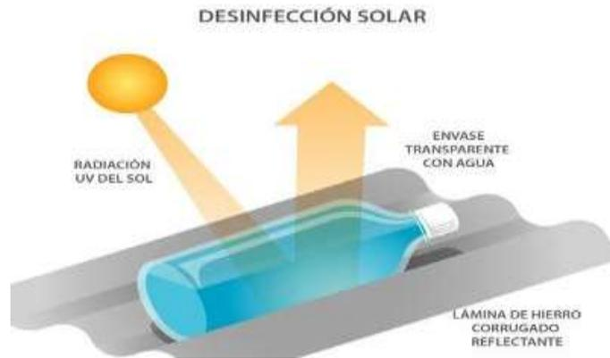
Gráfico 18 Desinfección solar del agua mediante SODIS.
