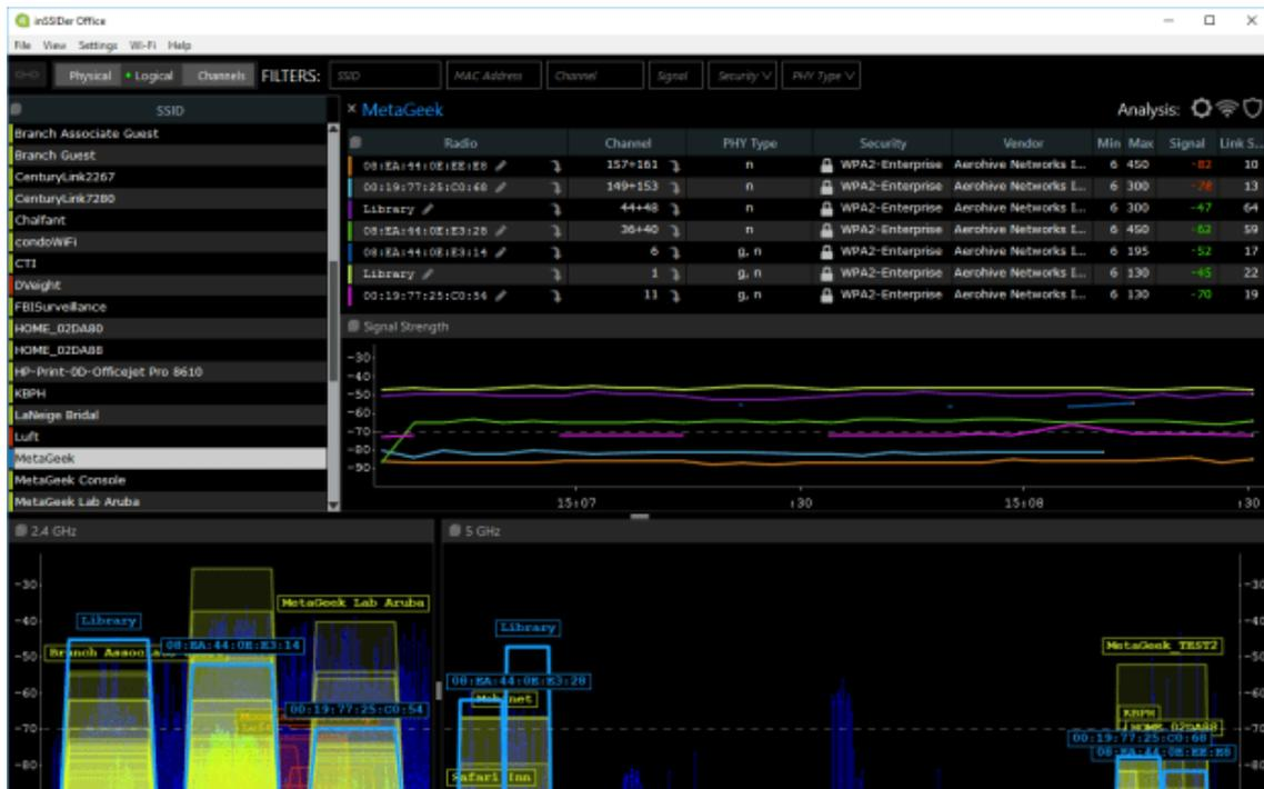
Ilustración 8 Análisis de Solapamiento de Canal
