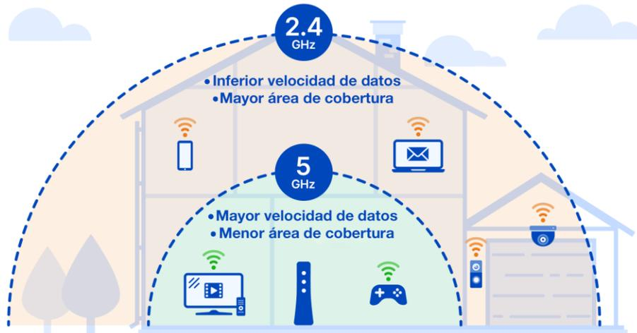
*Ilustración 3 Cobertura Inalámbrica en 2.4Ghz*
