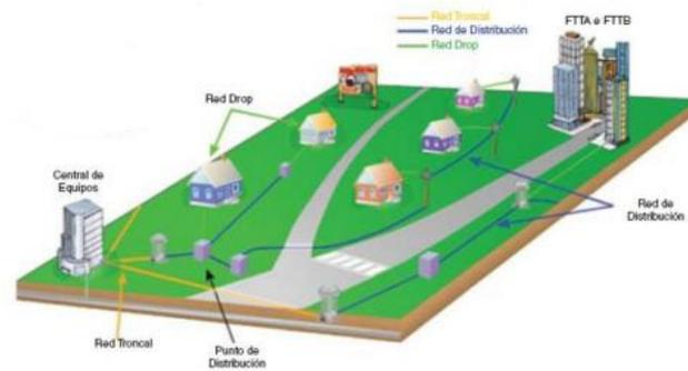
**Ilustración 8:** Esquema global de una red ODN, **Fuente:** Autor
