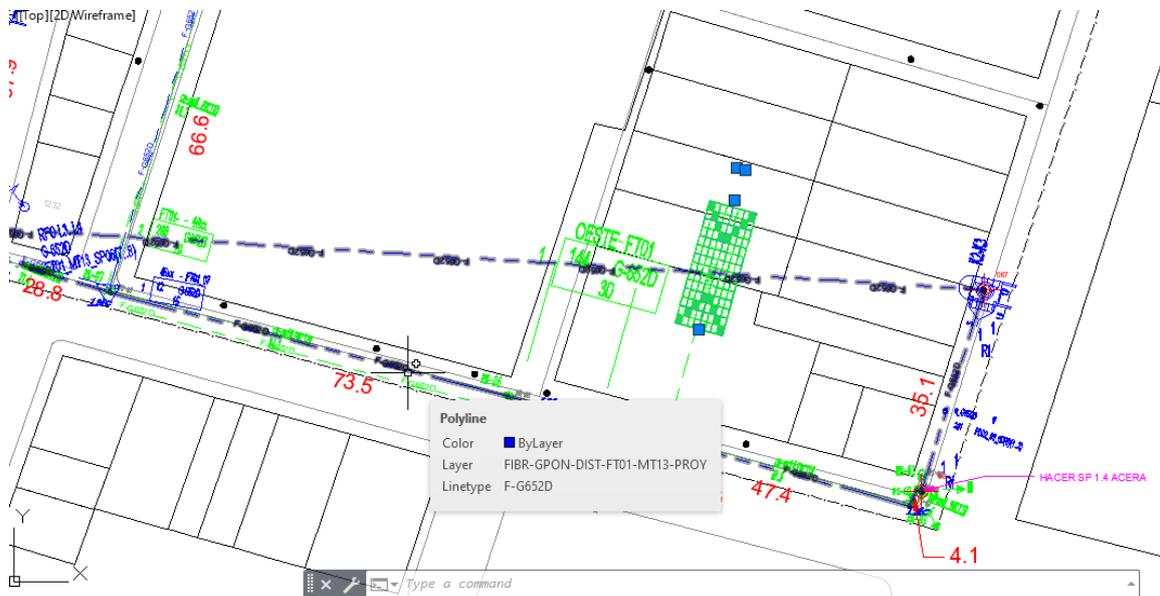
**Ilustración 18: Cable Fibra Óptica F-G652D, Fuente: Autor**
