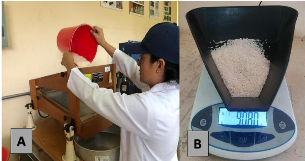
**Figura 8.** Colocación del producto masa blanca en una mini clasificadora GRAINMAN (A). Peso del producto arrocillo en la gramera eléctrica (B).
