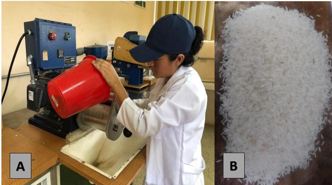
**Figura 7.** Colocación del producto integral en la mini pulidora de motor marca Grainman, molino MCGILL N3 (A). Producto masa blanca (B).
