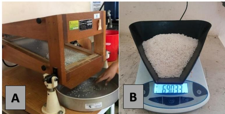
**Figura 9.** Obtención del grano flor en la mini clasificadora GRAINMAN (A). Peso del grano flor en la gramera eléctrica (B).
