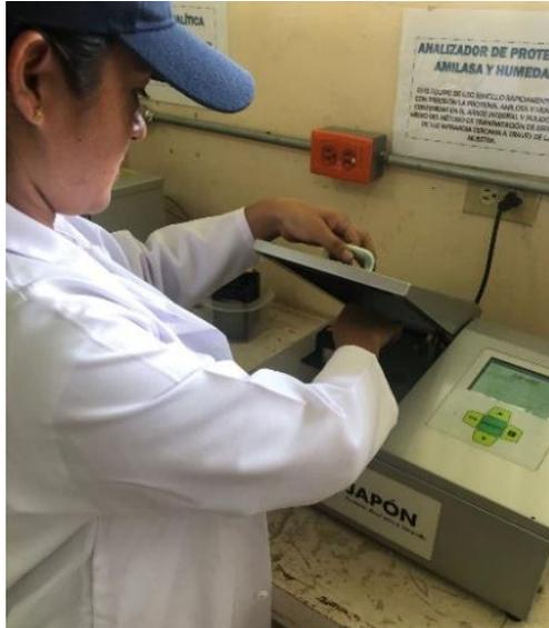
**Figura 10.** Medición del contenido de amilosa y proteína en el equipo marca Kett An-900, serie 0F00049.
