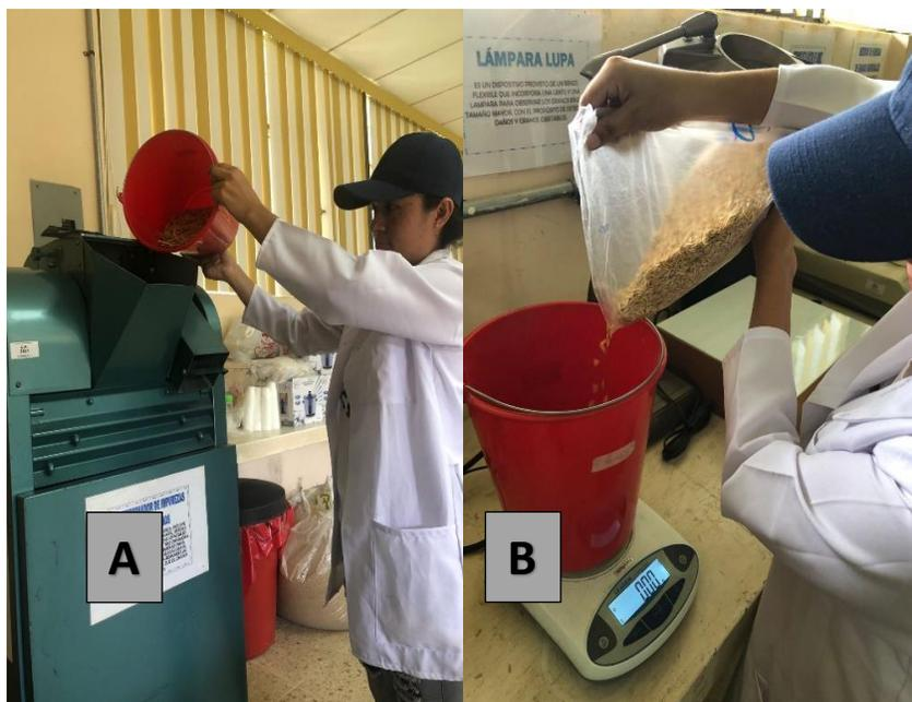
**Figura 2.** Limpieza de impurezas en el equipo marca Carter Day (A). Peso de la muestra sin impurezas en una gramera eléctrica (B)
