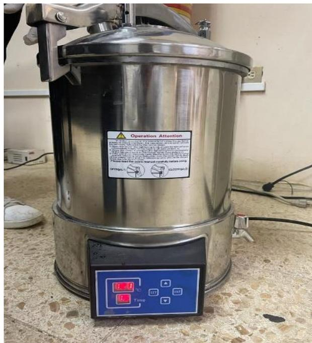
**Figura 7.** Esterilización de los materiales en la autoclave.
