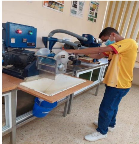
Figura 9. Pulido del grano de arroz integral.
