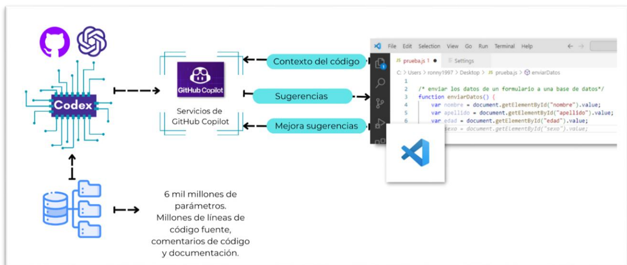
Figura 3: Funcionamiento de la herramienta Github Copilot
