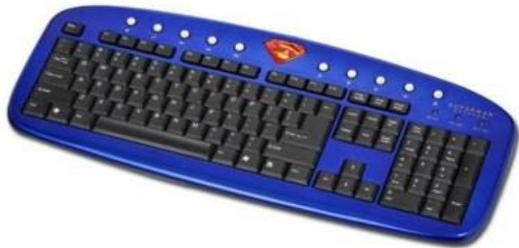
Un **teclado** es un periférico que consiste en un sistema de teclas, como las de una máquina de escribir, que te permite introducir datos a un ordenador o dispositivo digital.
