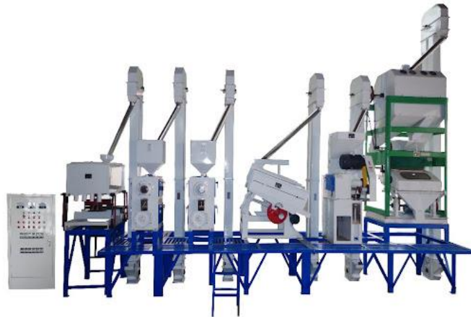
Figura 6 Línea de molino inteligente para arroz Fuente: (Machinery 2022)
