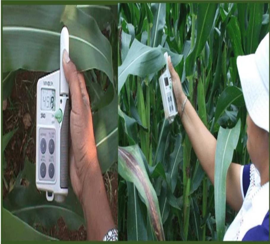
**Figura 3.** Medidor de clorofila SPAD
