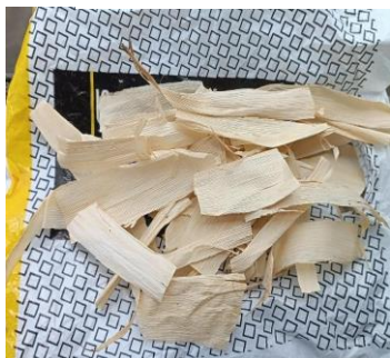
Ilustración 2: Proceso de limpieza y reforzamiento de la cáscara con ácido cítrico agua y NaOH.
