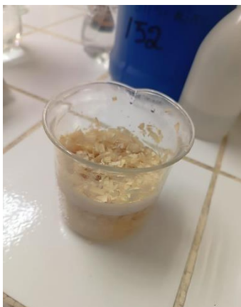
Ilustración 2: Proceso de limpieza y reforzamiento de la cáscara con ácido cítrico agua y NaOH.
