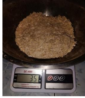
Ilustración 3: Proceso de pesado de la matriz polimérica y matriz vegetal.
