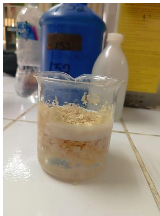
Ilustración 2: Proceso de limpieza y reforzamiento de la cáscara con ácido cítrico agua y NaOH.
