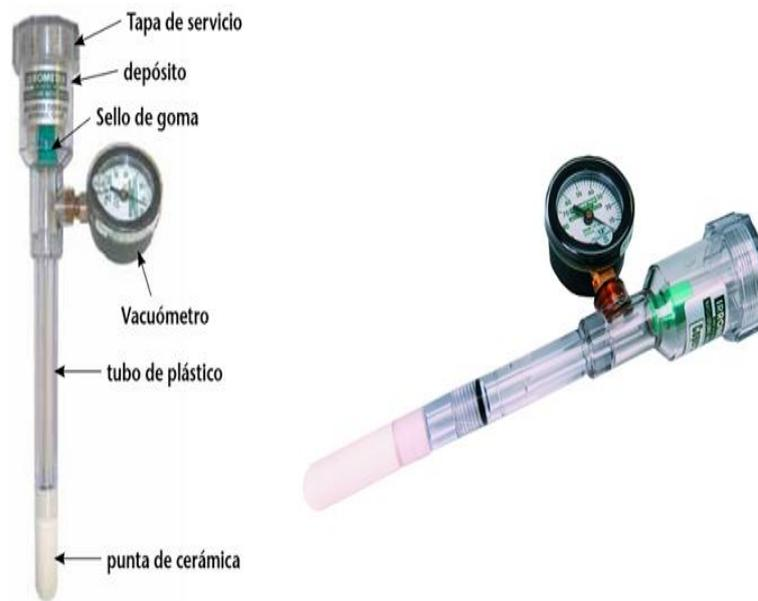
**Figura 1:** Partes del tensiómetro
