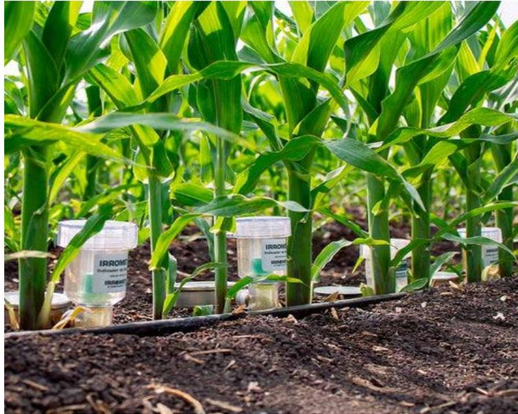
**Anexo 1.** Uso de tensiómetros en un cultivo de maíz con riego por goteo
