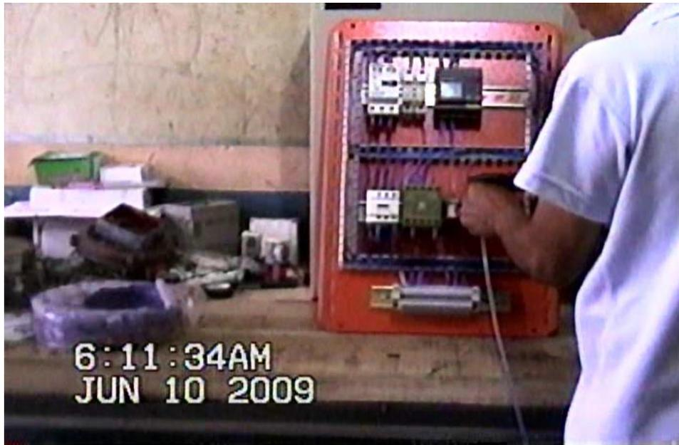
6. Todas las salidas y entradas están conectadas a las borneras y numeradas con marquillas para identificarlas.
