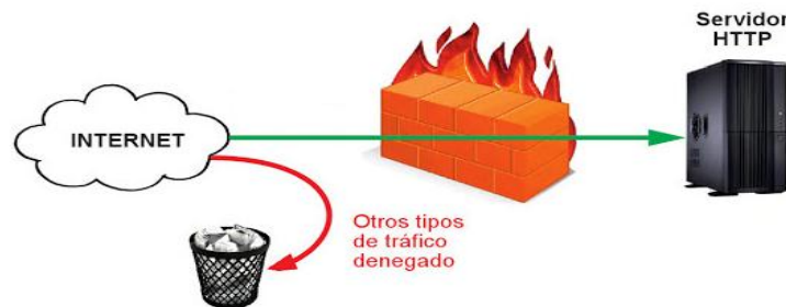
Figura 2. Cómo funciona un firewall. Valdivia, C. (2014)
