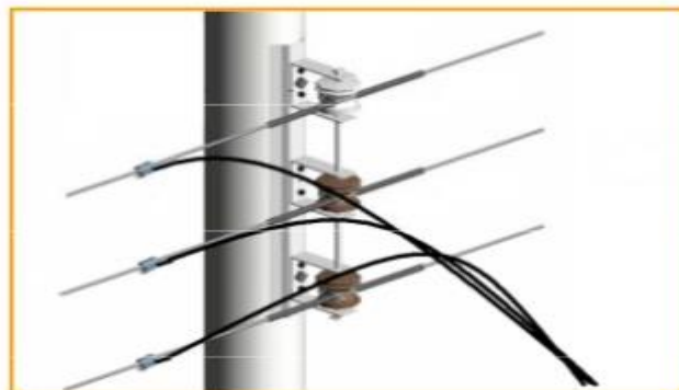
Fig. 6 (Red de baja tensión convencional descubierta)
