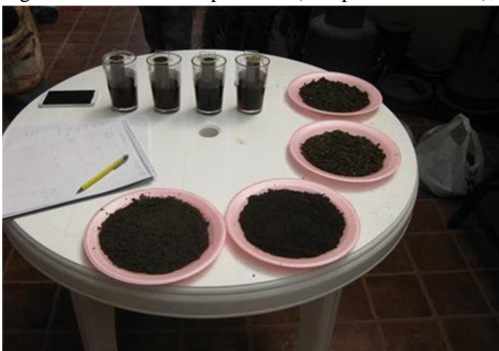
Figura 24. Material para prueba de velocidad de secado, FACIAG, UTB.
