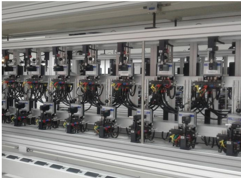
Figura 4 (contrastación de medidores en laboratorio)
