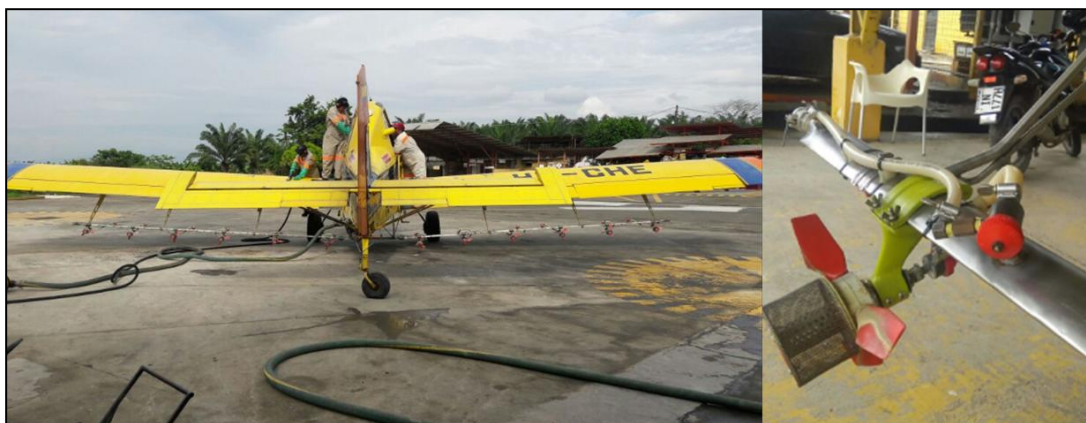
Grafico 40: Sistema Micronair AU 5000, adaptado en avionetas utilizadas en la investigación.
