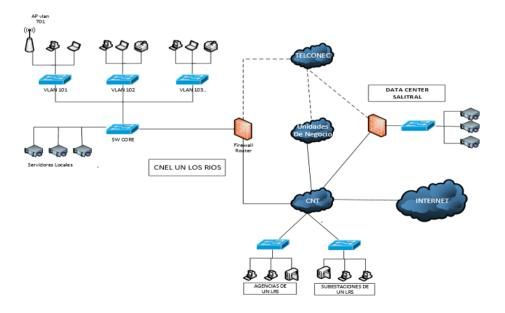
Figura 1.1: Diagrama de red de datos de una UN de CNEL EP
