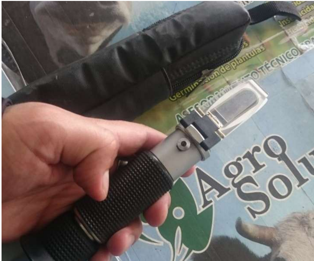
Fotografía 19. Refractómetro medidor de azúcares grados brix.
