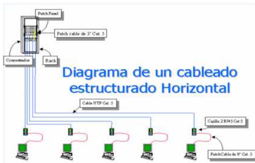
Figura 9, Red de Cableado Horizontal
