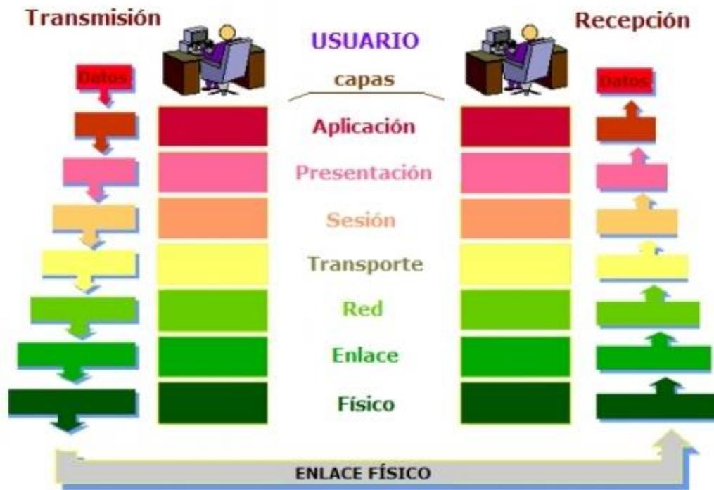
Imagen 2: Las 7 capas del modelo OSI
