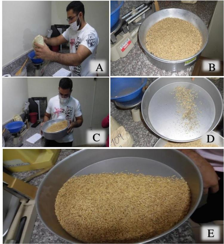
**Figura 2.** Procedimiento para obtener una muestra limpia. Peso de 250 g de arroz (paddy) en una balanza gramera (A); la muestra se coloca en una zaranda manual (B); Cernido de las impurezas de arroz en la zaranda manual (C); Impureza contenidas en la muestra de arroz (D); y arroz, paddy limpio y listo para su pilado (E).
