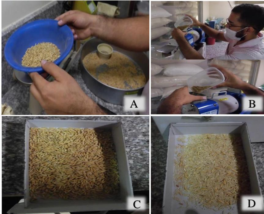
**Figura 5.** Peso de 100 g de arroz limpio para el proceso de pilado (A); Se colocan los 100 g de arroz limpio en la minipiladora para el descascarado (B); la minipiladora descascara un porcentaje de granos al primer pase (C); el arroz totalmente descascarado (D).
