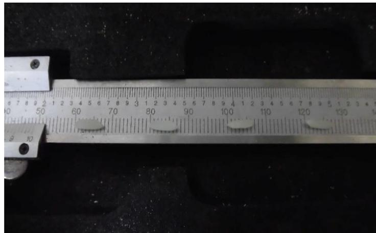
**Figura 11.** Con un calibrador tipo pie de rey, se procedió a medir el grano de arroz ya pulido.
