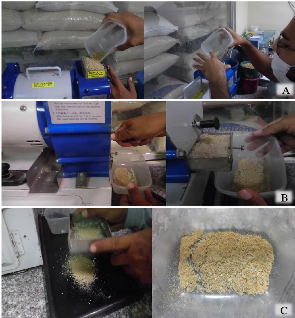
**Figura 8.** Pulido del arroz integral en una minipiladora por 30 segundos (A); colecta del pulido o masa blanca (B); y obtención del polvillo después de pulido (C).
