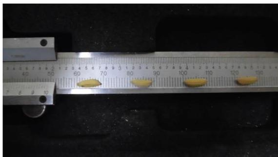
*Figura 4.* Medición el grano de arroz en cáscara con un calibrador tipo pie de rey.
