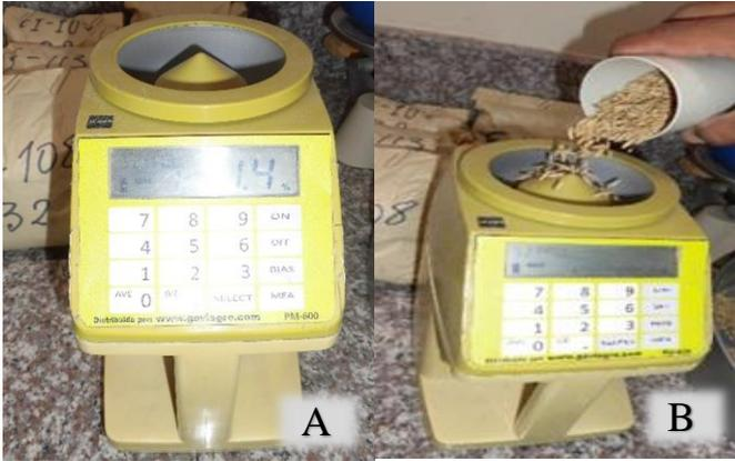
**Figura 3.** Determinador de humedad marca KETT PM-600 (A). Colocando 200 g de arroz en cáscara al determinador de humedad (B).
