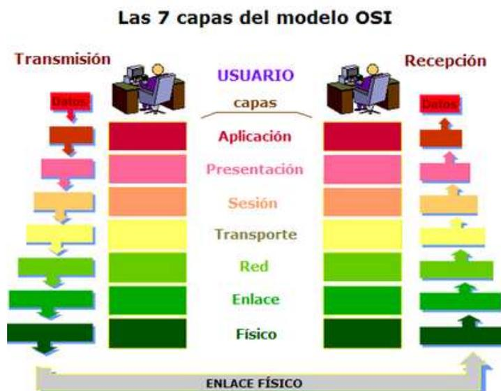
Imagen 1 Las 7 capas del modelo OSI
