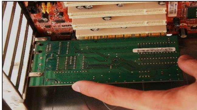
**Ilustración 2. Tarjeta de red de los computadores**
