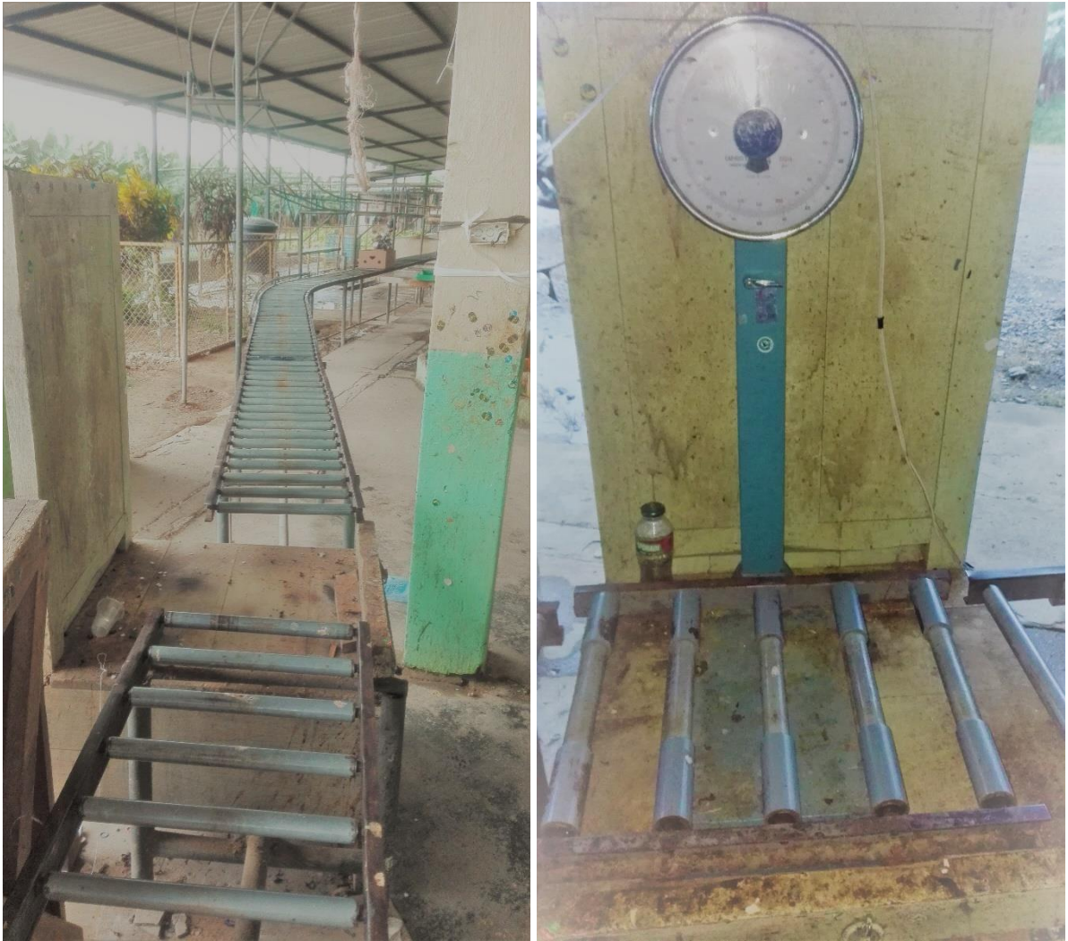
Figura 63: Visualización del área de pesaje y conteo de cajas
