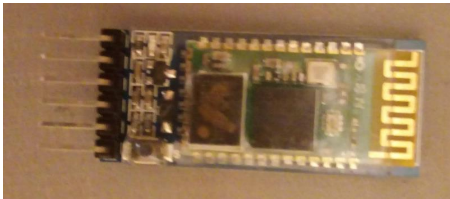
Ilustración 6. Modulo Bluetooth HC-05.
