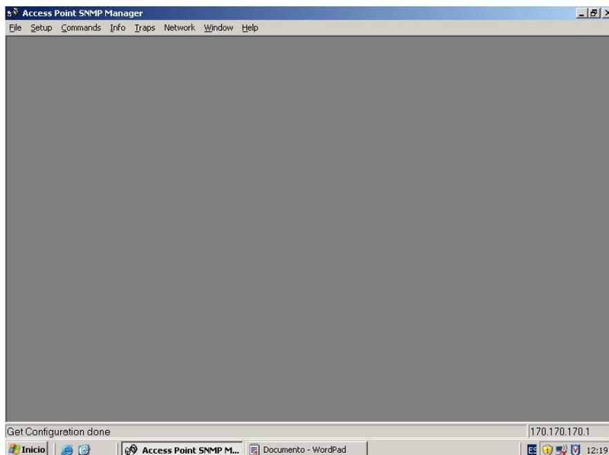
En la opción setup del menú principal se selecciona para asignar la dirección ip de la conexión, dirección de MAC, la dirección de la máscara y el Gateway
