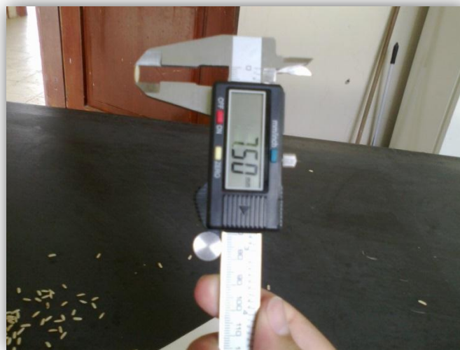
Figura 8. Medición de la variable Longitud de grano descascarado.
