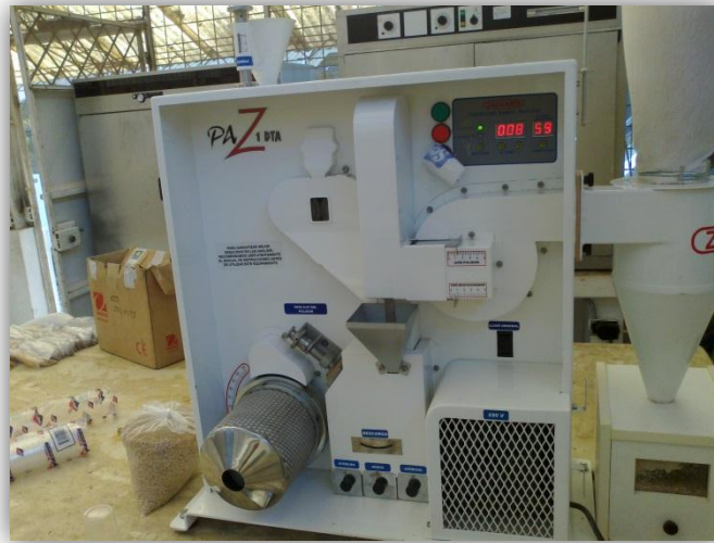
Figura 7. Mini piladora que se utilizó para descascarar y pulir los tratamientos.
