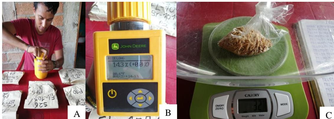
**Figura 13.- Colocación de semillas al humidímetro John Deere SW5300 (A); Lectura de una muestra de semilla (B); peso de 1 000 granos con una balanza gramera (C).**
