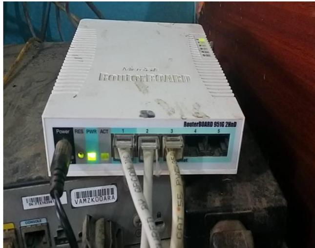
Figura 5, Equipo Switch de marca mikrotik
