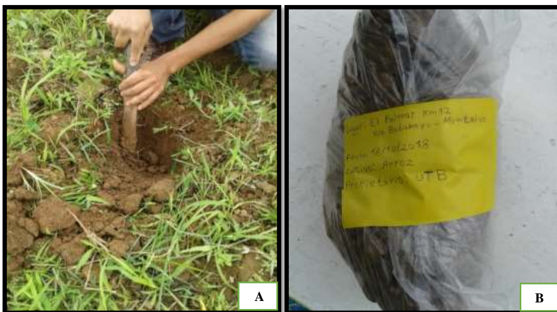
Figura N° 5. Toma de muestra de suelo (A); muestra representativa para el respectivo envío al laboratorio (B).
