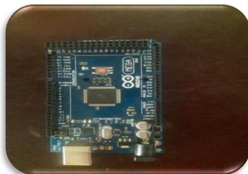
*Ilustración 7 Arduino mega*
