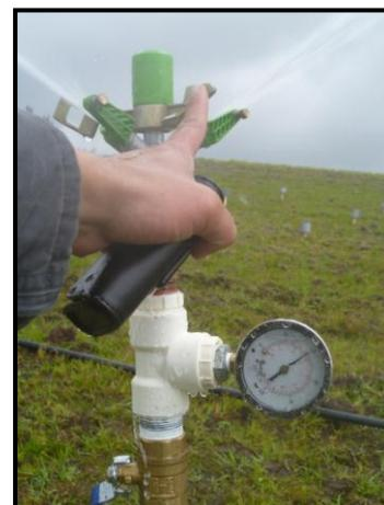
Fig. 14. Calibración de presión hidrostática en tratamiento 3 ROSI - 3B -  $\frac{3}{4}$ "
