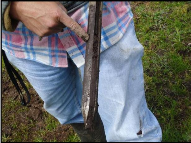
Fig. 17. Medición de la humedad del suelo con la ayuda de un barreno
