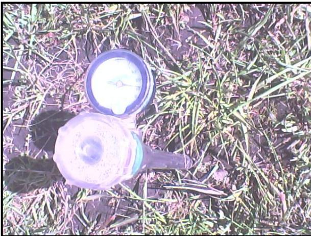
Fig. 19. Lectura de medición de la relación de humedad del suelo con tensiómetro
