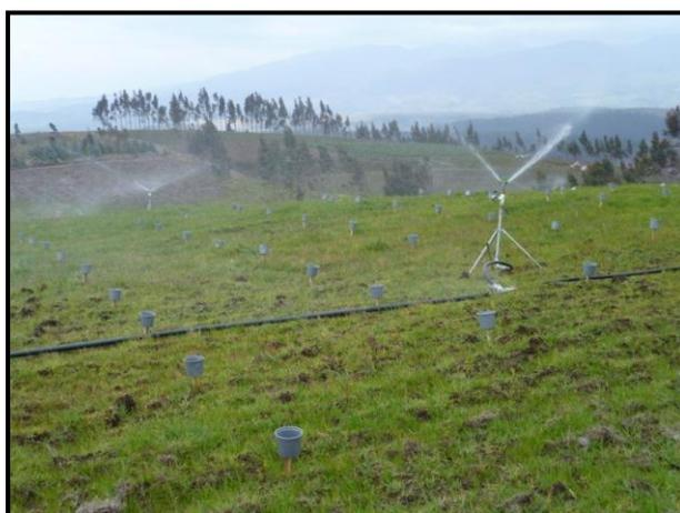
Fig. 15. Aplicación del riego y recepción de agua en pluviómetros
