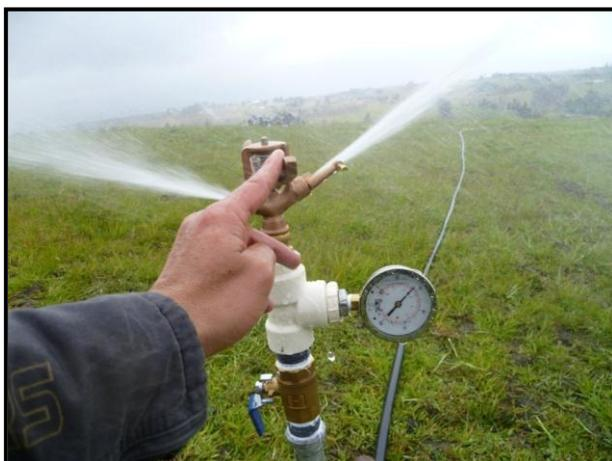
Fig. 13. Calibración de presión hidrostática en tratamiento 2 TROPPER  $\frac{3}{4}$ "
