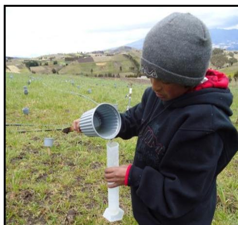
Fig. 16. Medición de pluviometría de los aspersores receptada en cada pluviómetro
