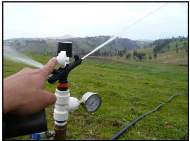
Fig. 12. Calibración de presión hidrostática en tratamiento 1 SENNINGER 3023 -2 -  $\frac{3}{4}$ "
