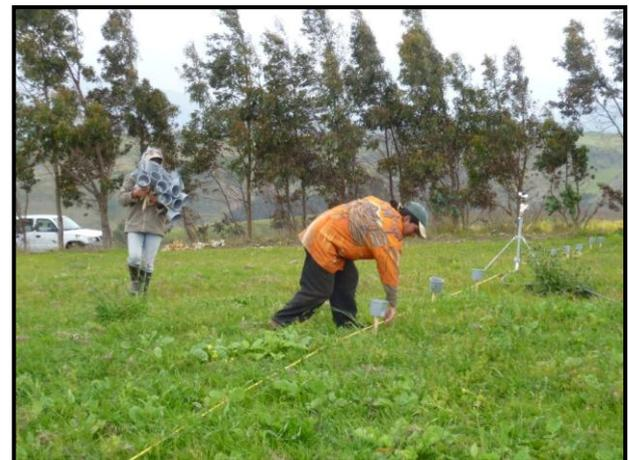
Fig. 10. Instalación de pluviómetros en parcela de investigación
