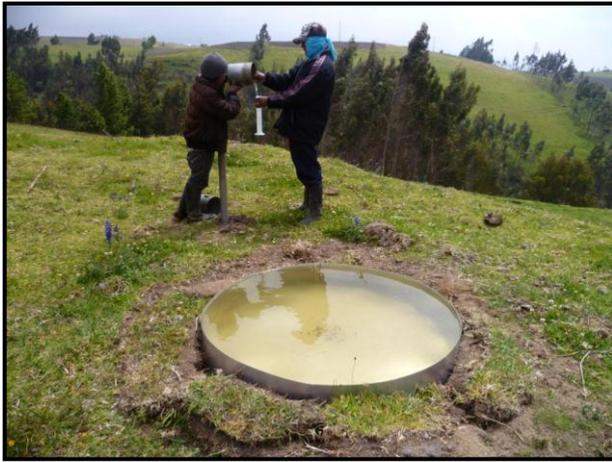
Fig. 5. Medición de agua lluvia desde pluviómetro en parcela de evaluación
