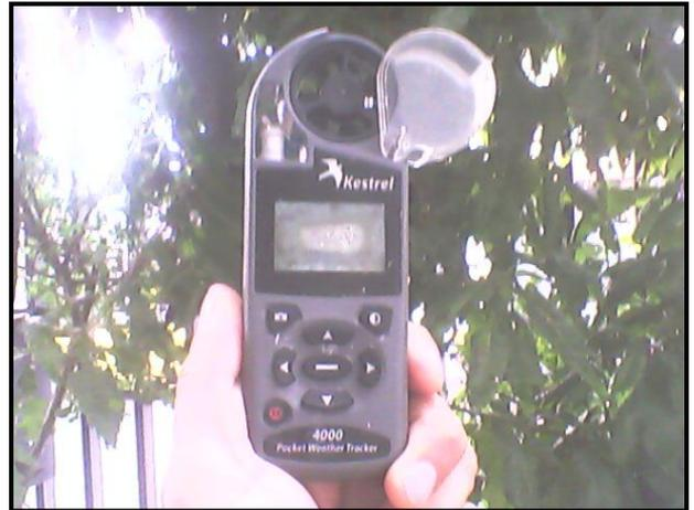
Fig. 6. Equipo de medición de factores climáticos (viento, temperatura, humedad)
