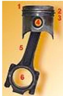
**Figura N 16. Estructura del pistón**
