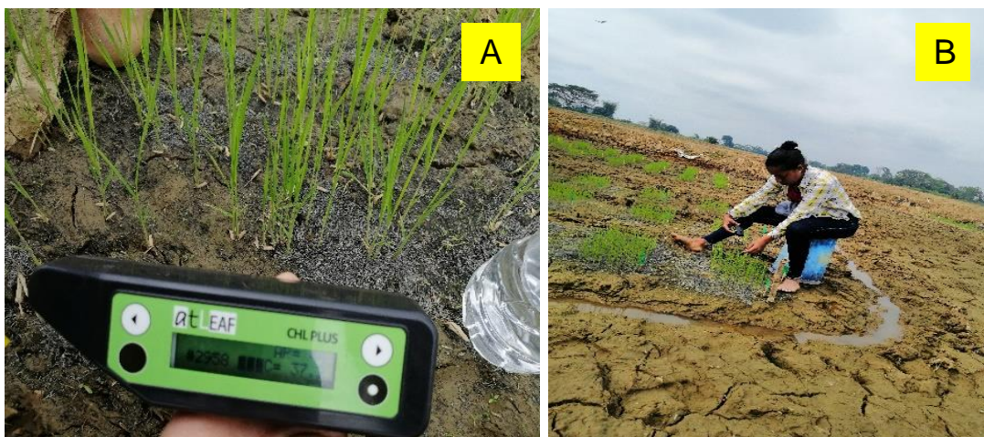
Figura 7. Evaluación del contenido de clorofila utilizando el equipo Marca At Leaf, modelo CHL Plus en 20 individuos al azar de cada tratamiento (A) y (B).
