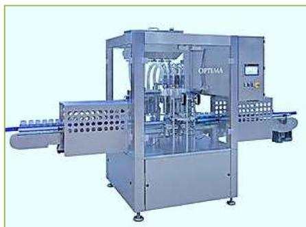
**Ilustración 40** Máquina de llenado automático
