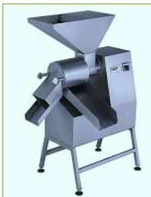
**Ilustración 36** Máquina despulpadora
