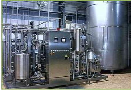
**Ilustración 42** Maquina de pasteurización
