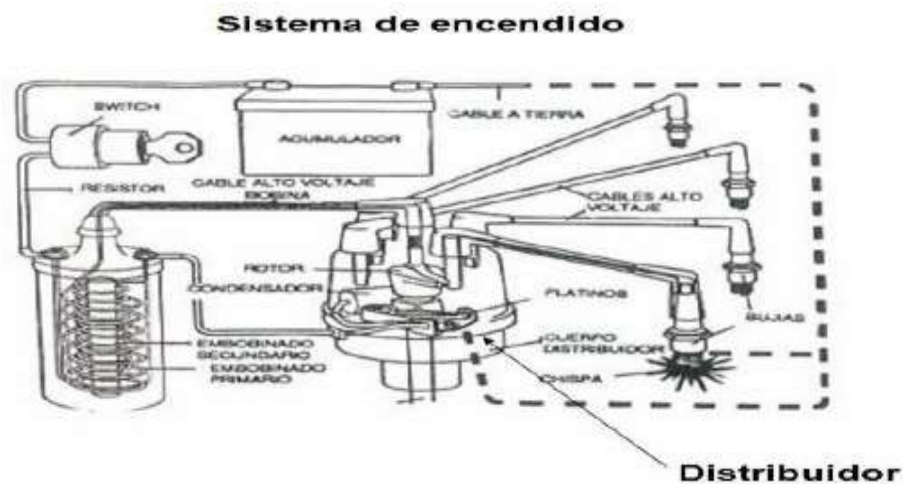
Figuras 54 El distribuidor o delco
