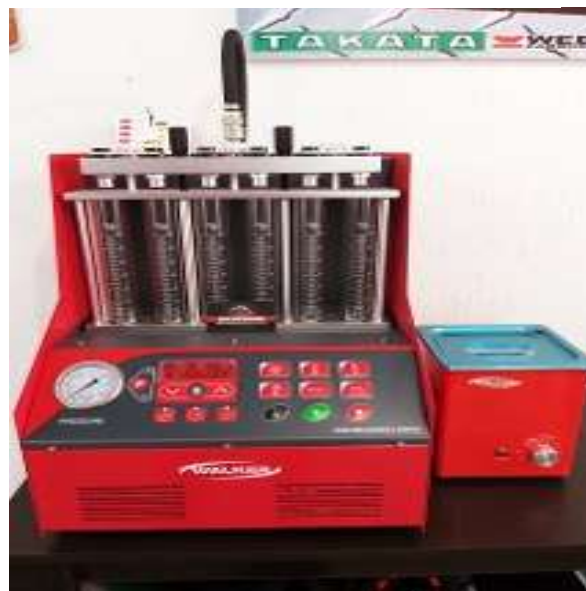
Figuras 23 Limpieza de inyectores
