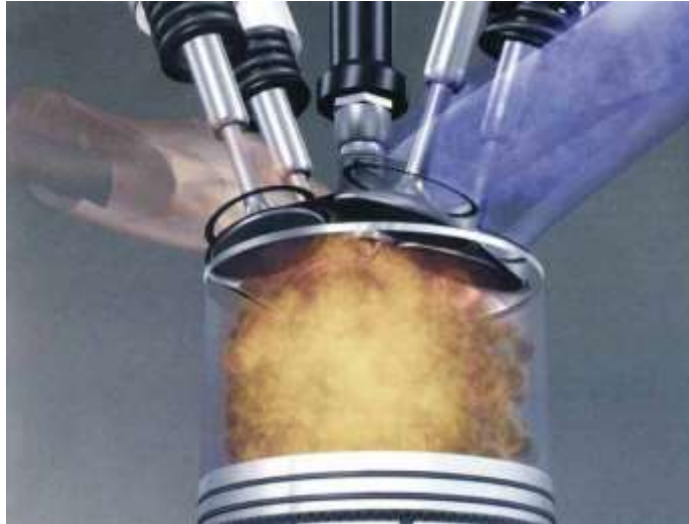
Figuras 33 Cámara de combustión
