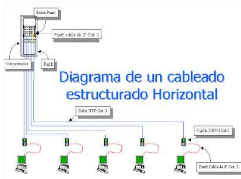
*Ilustración 6. Cableado Horizontal. (Perea, 2016)*
