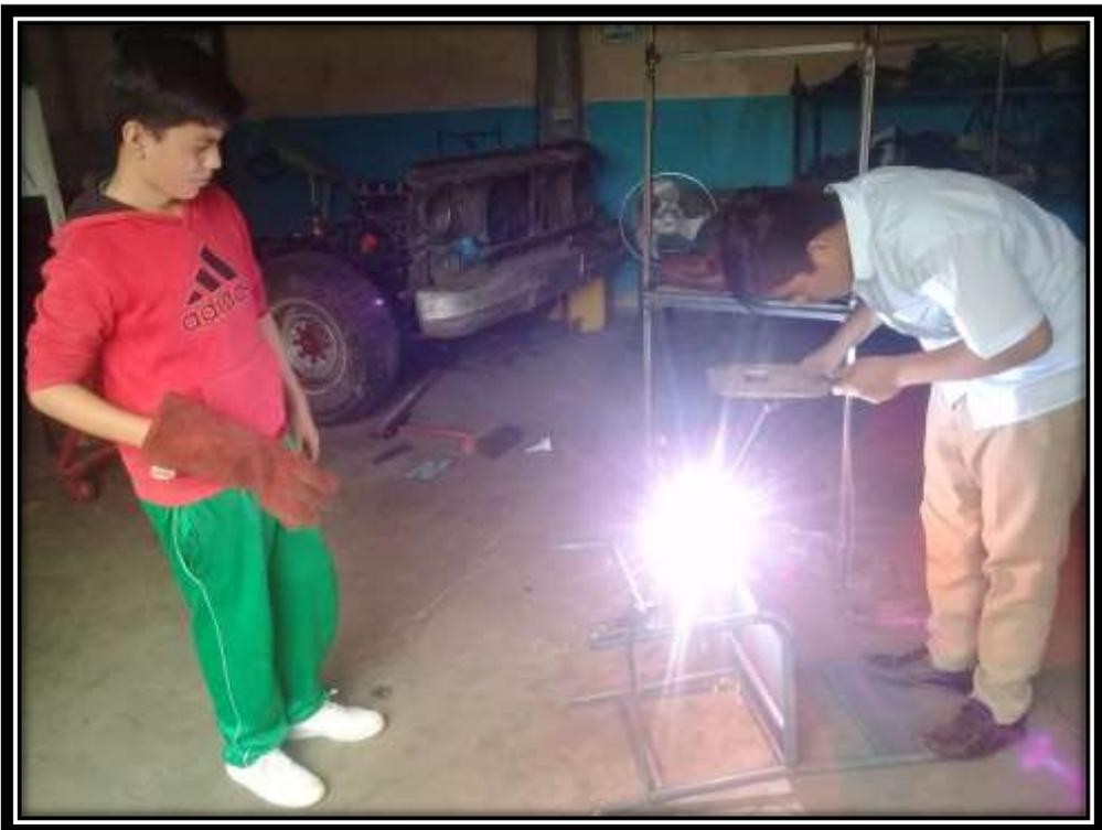
**Fig.6. foto. Trabajo de soldadura en arreglo de silla metálica**
