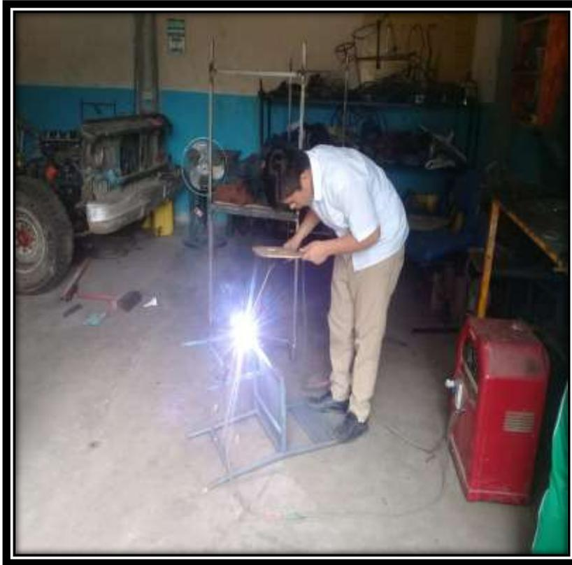
Fig.8.foto. arreglo de silla metálica y efecto del arco eléctrico en la vista del estudiante
