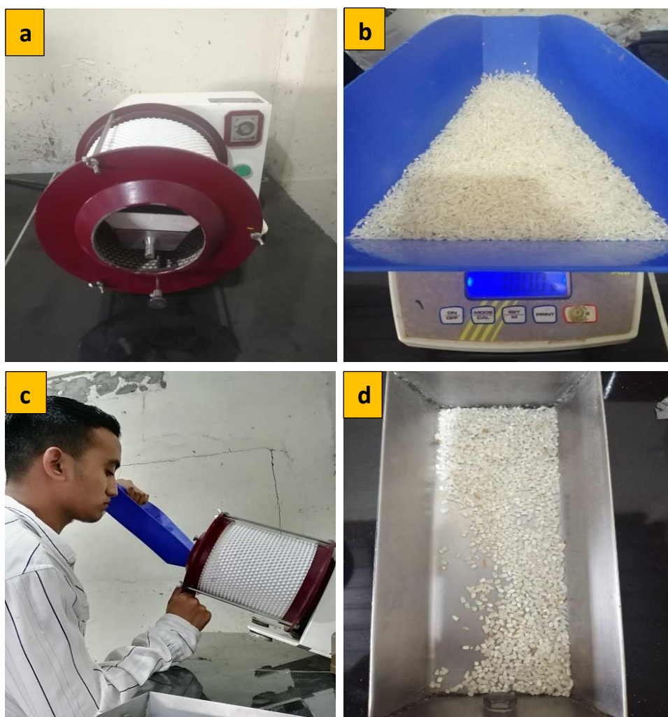
Figura 8. Cilindro clasificador (a), peso de 100 gramos en la balanza digital (b), ubicación de granos en el cilindro (c), arroz quebrado o arrocillo colectado en la muestra de 100 g (d).
