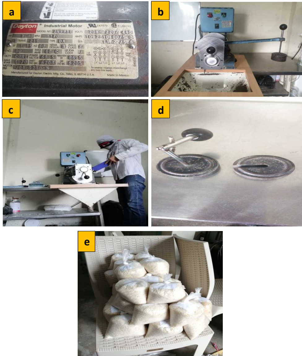
Figura 7. Marca del motor de la pulidora (a), pulidora de capacidad máxima de 800 g (b), colocación de muestra (c), pesas que se ubicaba en la palanca encima del cilindro (d), muestras pulidas (e).
