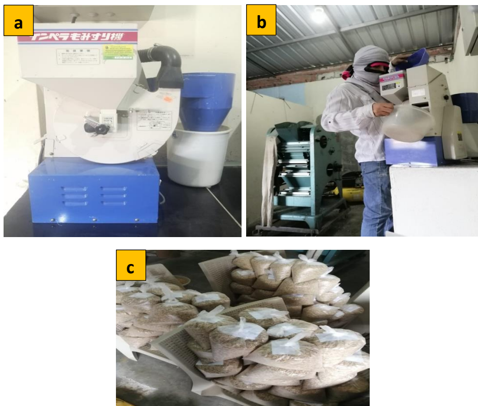
Figura 5. Máquina de descascarar (a), proceso de descascarado (b) y obtención de muestras descascaradas (c).
