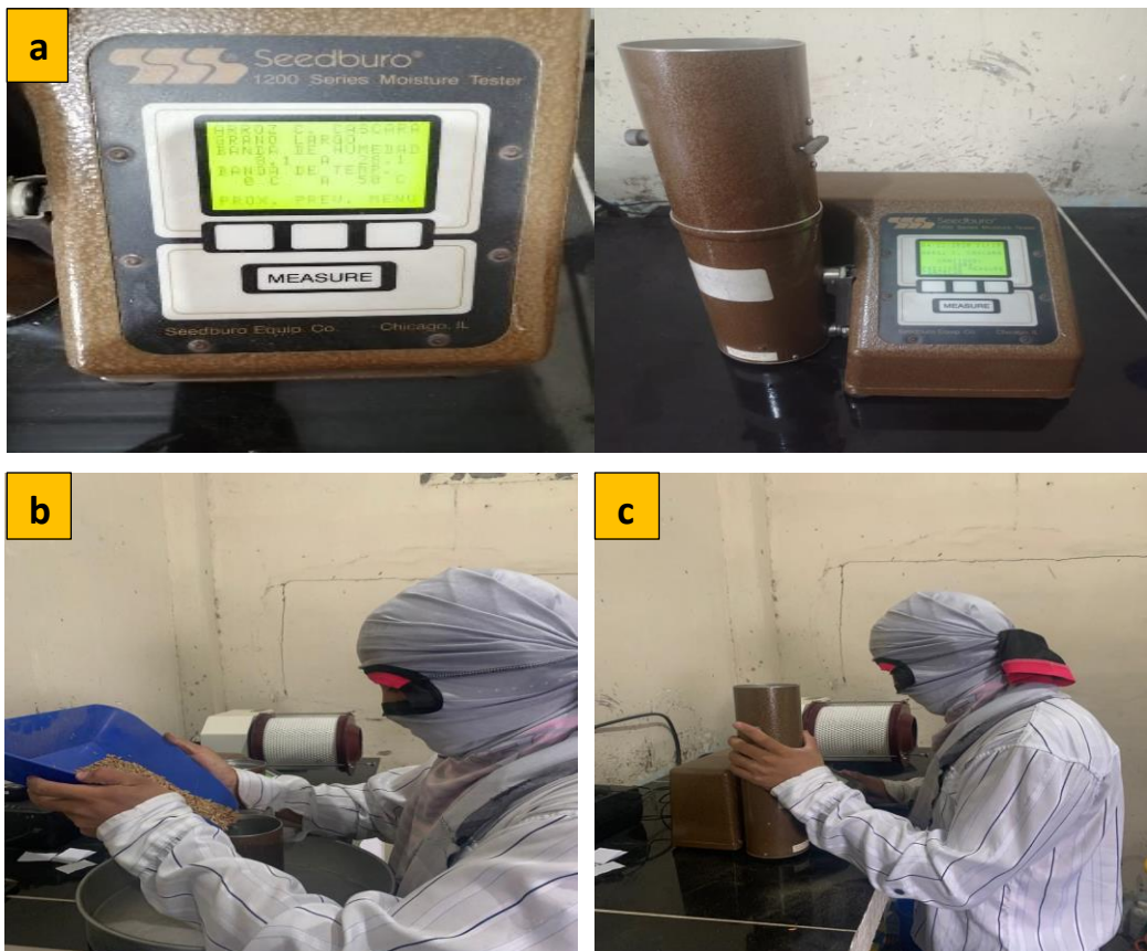
Figura 3. Equipo detector de humedad (a), peso de 200 gramos de muestra limpia (b), muestra colocada en el cilindro y utilización de la máquina (c).
