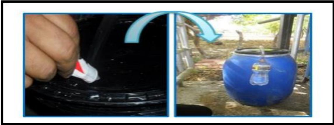
Figura 6. Perforación, instalación del proceso anaeróbico y sellado del barril herméticamente
