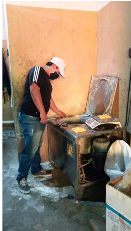
Ilustración 2 Mezcladoras en mal estado Fuente: Fotografía tomada por el autor
